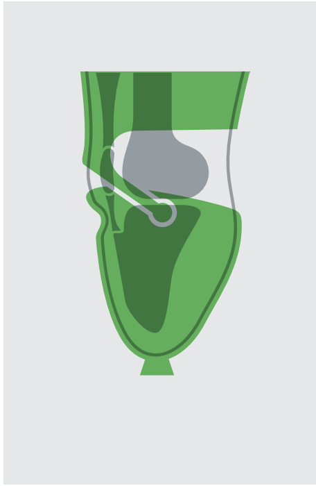
Protesi PTB (Patella-Tendon-Bearing) (1963, Prof. C.W. Radcliffe, Stati Uniti)
